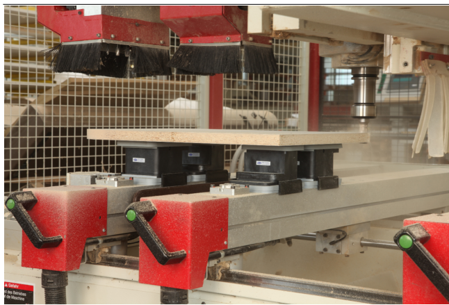
Блочная присоска VCBL-K2 при закреплении заготовки
